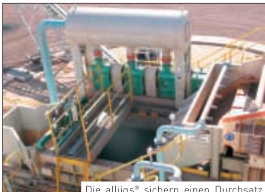
Die alljigs® sichern einen Durchsatz von bis zu 120 Tonnen pro Stunde. alljigs® guarantee a throughput of up to 120 tons per hour.
