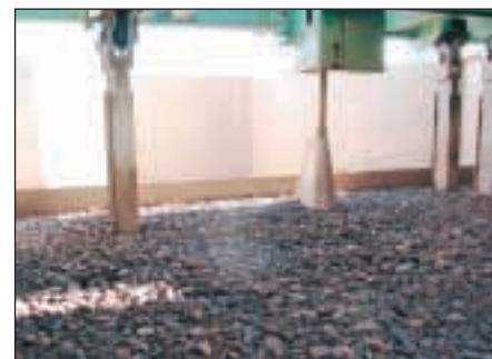
Die alljigs® sichern einen Durchsatz von bis zu 120 Tonnen pro Stunde. alljigs® guarantee a throughput of up to 120 tons per hour.
